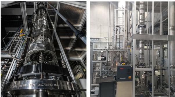
**Abbildung 1:** Gaswäsche zur Abscheidung von CO<sub>2</sub> aus Feedgasen am EBI.
