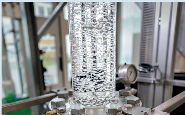
Bild 1.7: Hydrodynamik in Blasensäulen im homogenen Strömungsregime: d_R = 100 mm, Wasser/Luft.
