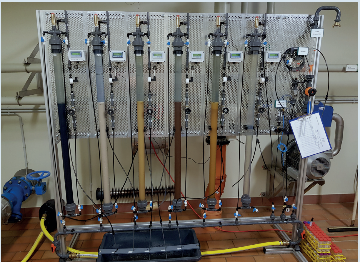
Bild 4.8: Um technische Lösungen für die Entfernung von Vanadium aus dem Trinkwasser zu entwickeln, wurden in Zusammenarbeit mit einem Wasserversorger in Rheinland-Pfalz halbtechnische Untersuchungen zur Adsorptions- und Flockungsfiltration durchgeführt.
