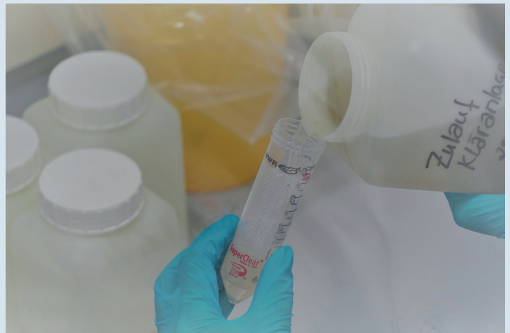
Bild 4.7: Proben aus einem Kläranlagenzulauf.
