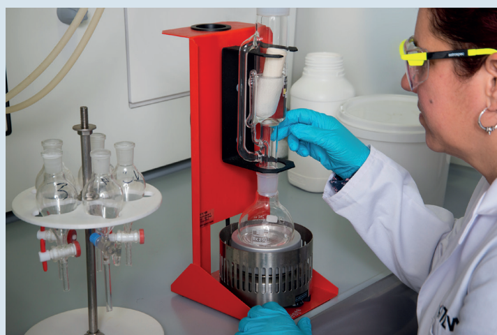
Bild 4.9: Im Labor der Prüfstelle werden Materialien im Kontakt mit Trinkwasser geprüft, hier Dichtungen (Elastomeren) mit einer Soxhlet-Apparatur.
