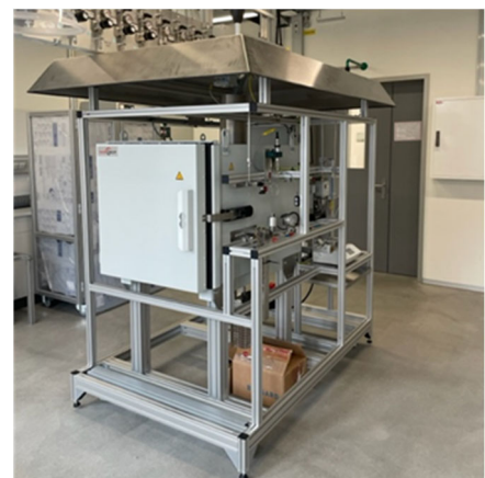
Abbildung 3: Sorptionsapparatur zur Bestimmung von Henry-Koeffizienten
