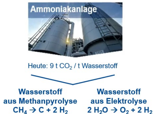
Abb. 6: CO 2 -Footprint am Beispiel der Ammoniaksynthese für unterschiedliche Herstellungsprozesse [12]
