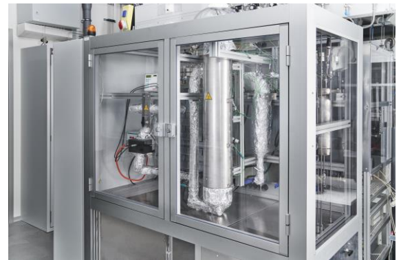
Abbildung 1: Dreiphasen Festbettreaktor zum Hydroprocessing von FT-Wachsen
